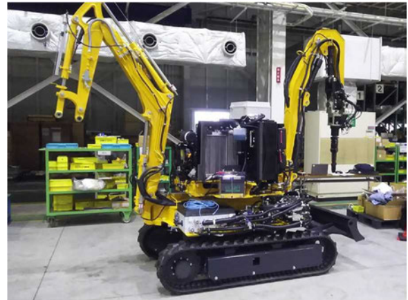
図 6 2 重旋回・複腕モデル (外装を外した状態)
