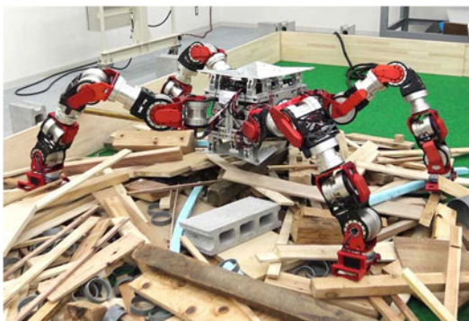
図1 WAREC-1のがれき路面での腹ばい移動
