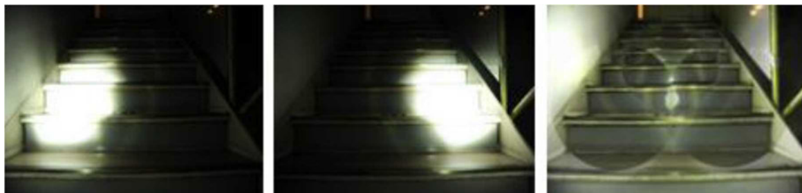
図1 白とび・黒つぶれ補正結果(左:入力画像1, 中央:入力画像2, 右:出力結果)
