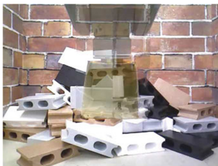
図2 半隠消映像生成結果(本来透明ではない手前のロボットアームを画像処理により半透明に変更)
