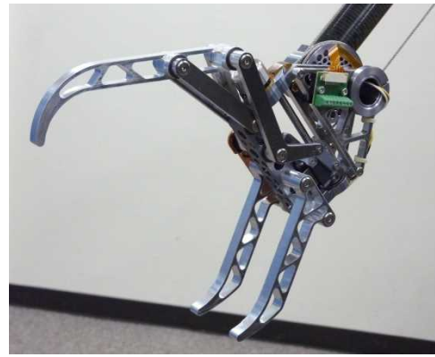
(図左)ロボットアーム 3D CAD, (図中)製作したロボットアーム, (図右)製作したロボットハンド
