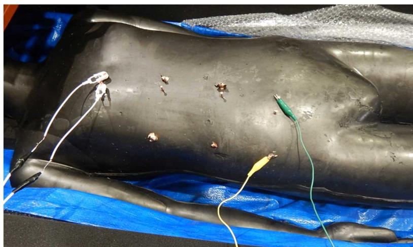
図1 計測中の電気インピーダンス評価用人体ファントム
