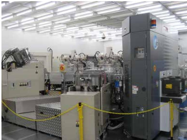
図 2 磁性膜スパッタ装置
