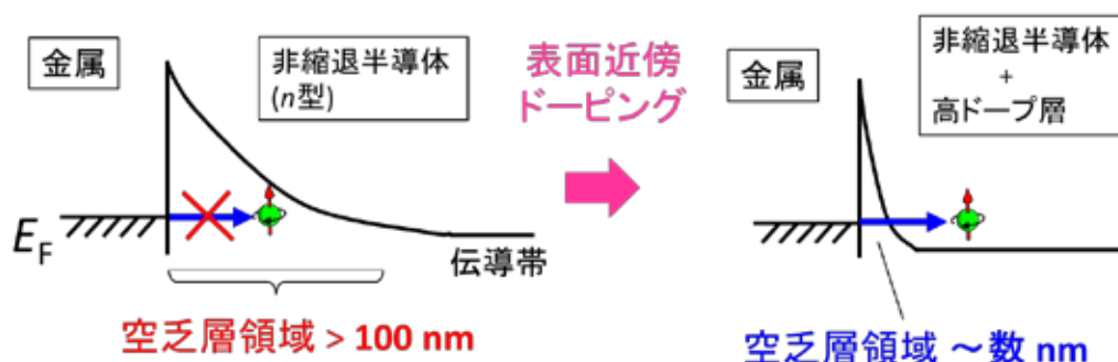
図1 強磁性/非縮退半導体接合のエネルギーバンドに及ぼす界面近傍への高キャリアドーピング効果。ドーピングにより空乏層領域が減少し、スピン注入に必要なトンネル伝導が支配的になる。
