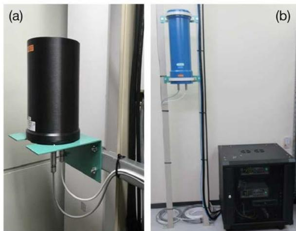
図 2. 設置したエリアモニタ。(a)前方モニタ、(b)側方モニタ並びに 2 台の電位計などを収納したラック。
