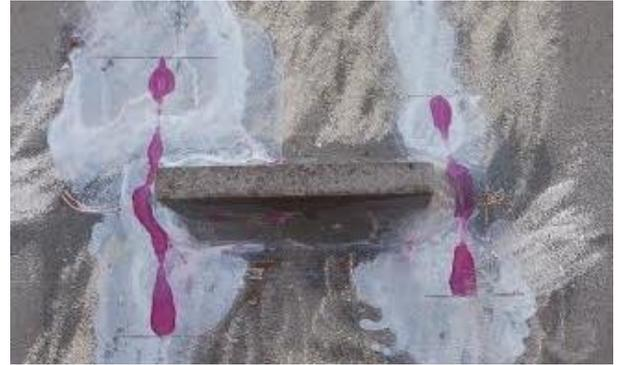
図5 疲労き裂の発生位置(ショットピーニング)
