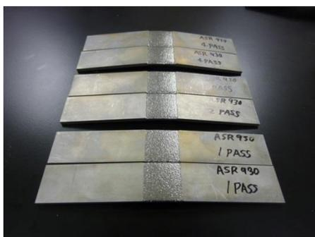
図1 3mm材フォーミング施工試験片
