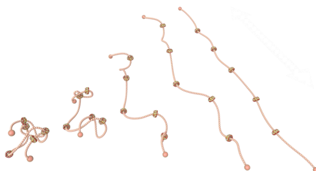
図1 エラストマー伸張に伴うPR架橋剤の分子構造の変化を示した概念図
