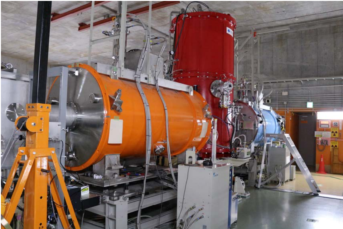
図3 RI ビーム減速・収束装置 (OEDO 装置)
