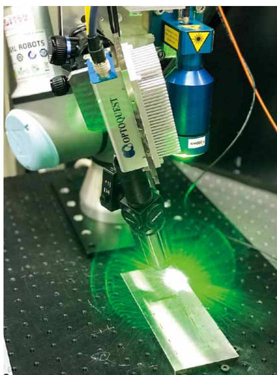
【写真3】ハンドヘルドレーザーによる欠陥検査
