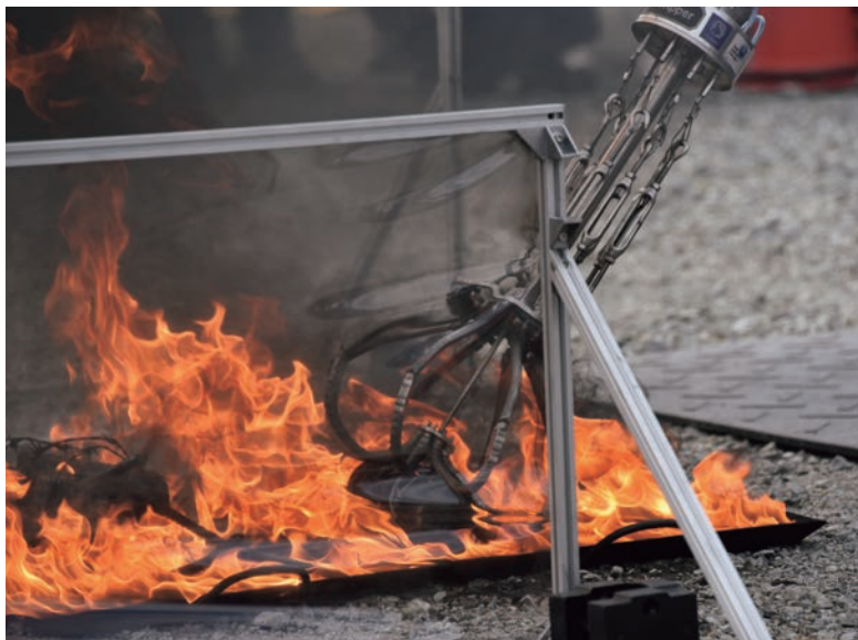
【写真4】炎の中でもモノをつかめるロボットハンド
