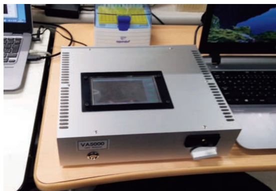
[写真1] ナノポア検出チップを搭載した細菌、ウイルス計測のプロトタイプ装置
