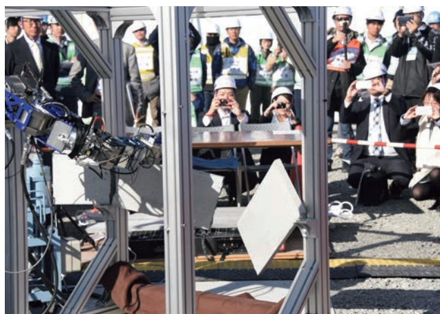
【写真7】コンクリート壁を割る油圧アーム
