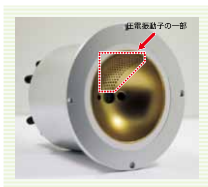
【図2】多チャンネル球面状超音波センサ
