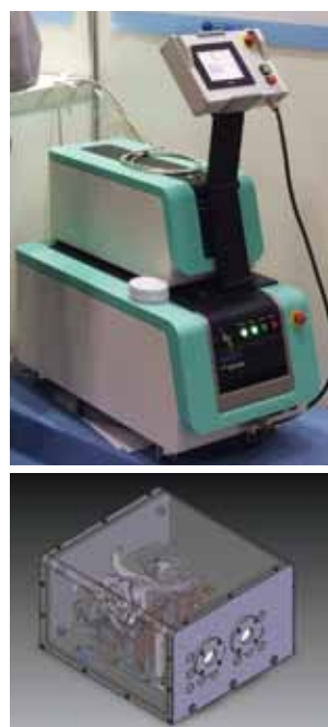
【図3】ワイドフィールド可視化装置(左)とランプ励起2波長可変レーザ装置モックアップ(右上)、波長可変レーザ部(右下)
