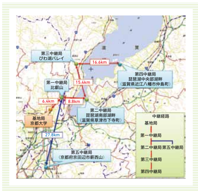
図7 広域データ伝送試験における無線局設置場所
