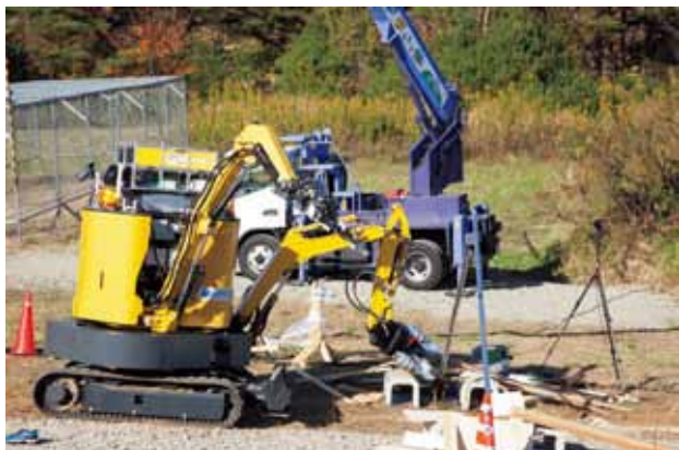
【図2】複腕を使って、パイプを持ちながら切断する建設ロボット
