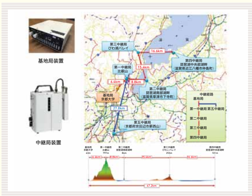
▶ 広域データ伝送試験における無線局設置場所
