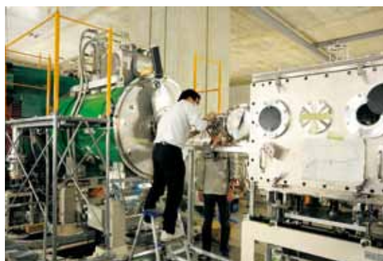
【図5】不安定核ビーム低エネルギー化装置「OEDO」の測定装置
