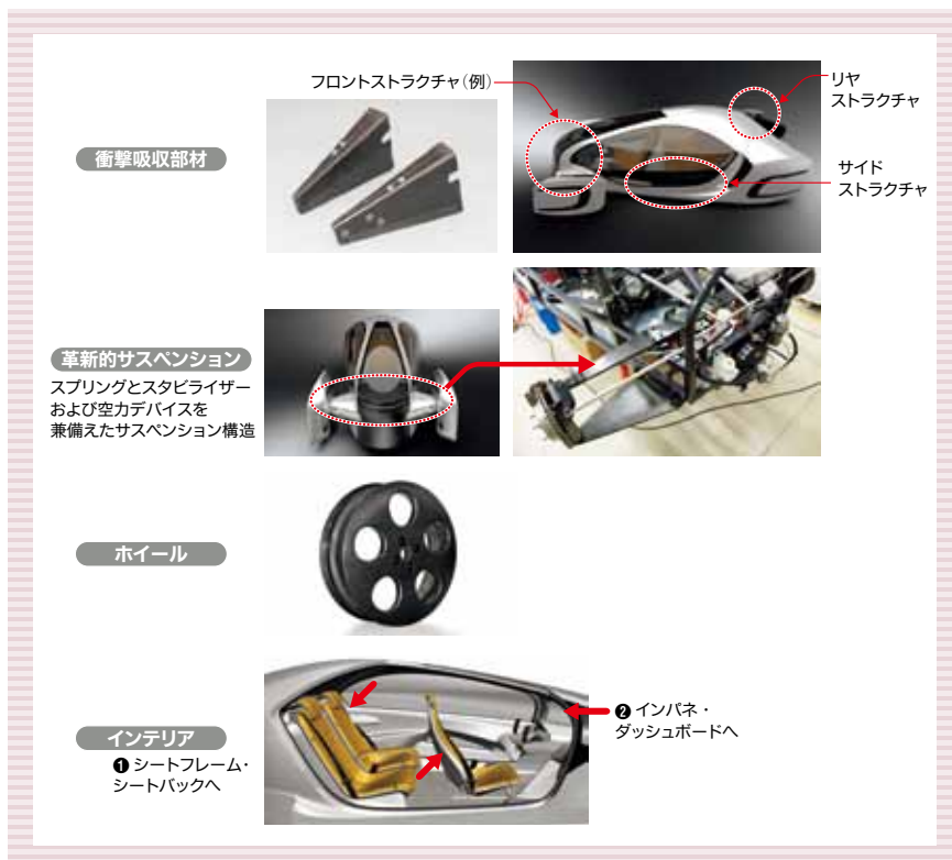
【図5】コンセプトカーで使われているタフポリマー
