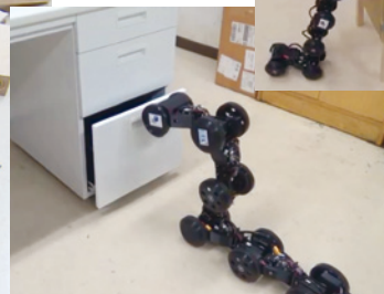
持ち上げた 先頭部で作業
