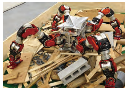
WAREC-1の腹ばい歩行の様子。胴体部を積極的に接地させることにより、高い安定性を保つ
