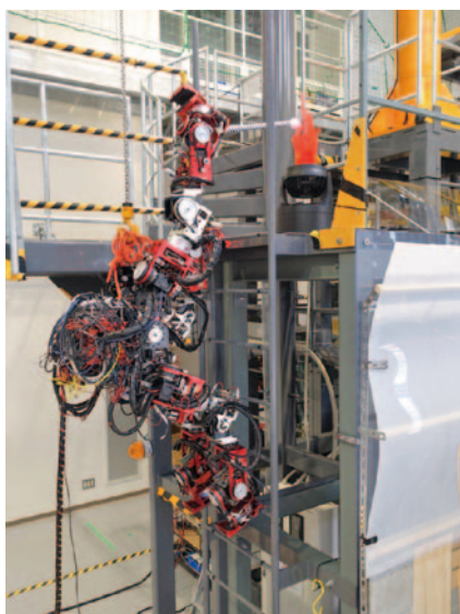
プラントのはしごを登る脚ロボット
