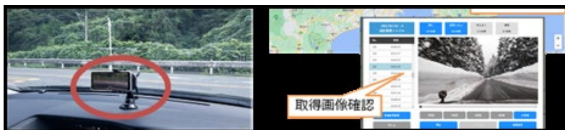
図 2.3.7 スマホ AI 路面判定試験システム
