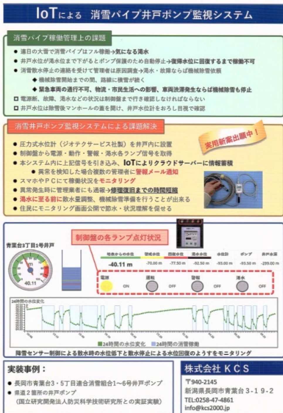
図 2.3.8 消雪パイプ井戸ポンプ監視システム
