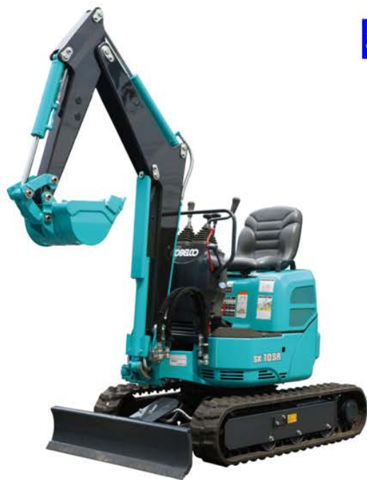
複合材製アーム・ブーム 油圧ショベル取付状態(実物)
