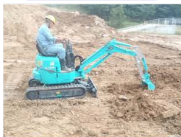
複合材製アーム・ブーム 油圧ショベル取付状態(実物)
