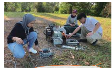
観測装置設置場所選定のため 電波環境の予備測定を行っている様子
