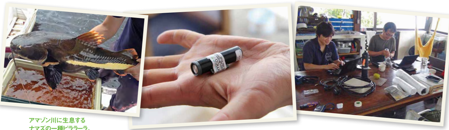
小型の記録計。ナマズの腹部に埋め込み、放流して移動パターンに関するデータを採る。
