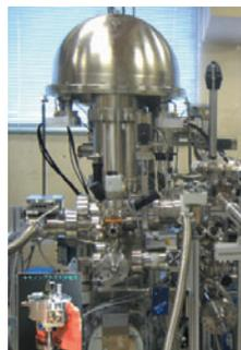
電子は通常、有限の質量をもって運動していますが、ディラックコーン状態と呼ばれる特殊な状態になると、高速に近い速度で運動する質量ゼロのディラック粒子となることが理論的に予想されていました。右は、角度分解光電子分光の検出装置。物質に高輝度紫外線を照射し、光電子のエネルギー状態を精密に測定します。
