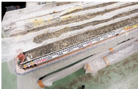
地質調査から持ち帰った土の試料。ジオスライサーと呼ばれる長い桶のようなものを地面に突き刺して、年月を経て堆積した土を採集する。
