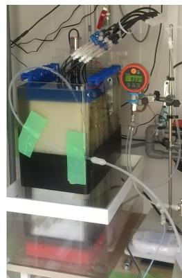
図2 膜ろ過モジュールの外観
