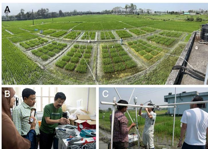
(A)BAU圃場に設置した水管理実験区。(C)に示す気象センサー、Eh、体積含水率、これらを記録するデータロガーを設置した。(B)測定機器の加工をカウンターパートに技術移転した。
