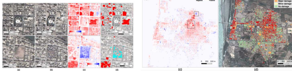
図 24 2007 年ピスコ地震前後の WorlView-2 衛星画像に AI モデルを適用して推定した建物変化と地震後の被害調査結果との比較 (a:地震前画像の建物分布、b 地震後画像の建物分布、c:AI モデルにて推定した建物変化、d:現地調査結果)
