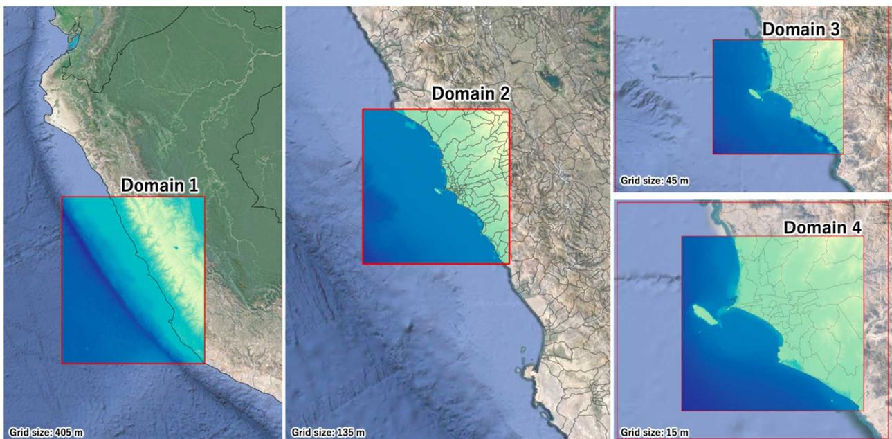
図7 津波浸水被害予測シミュレーションの領域設定（メッシュ配置）
