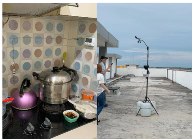
図 13 長期実測調査の様子(左: 温湿度計，右: 気象ステーション)
