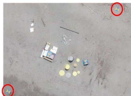
図2 ドローン空撮から得られた海岸画像。赤丸は対空標識を示す。地上画素寸法は5mm(上空17mから撮影)。
