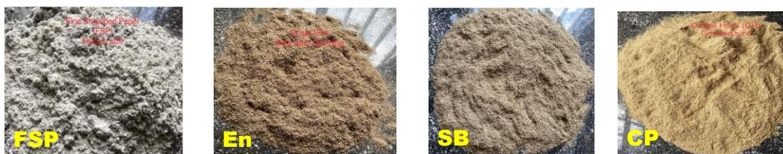
図 1-5 粉体の様子 (EN：エンセーテ，SB：サトウキビバガス，CP：コーヒー殻)
