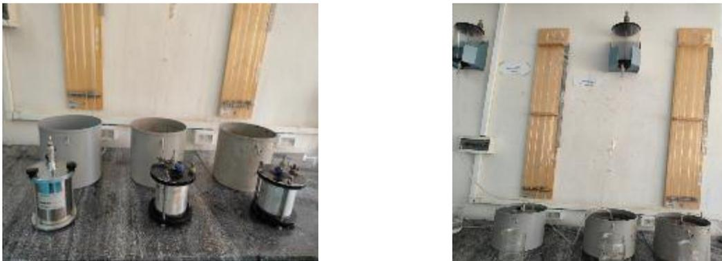
図 1-12 変水位透水試験実施状況 (アジスアベバ科学技術大学)
