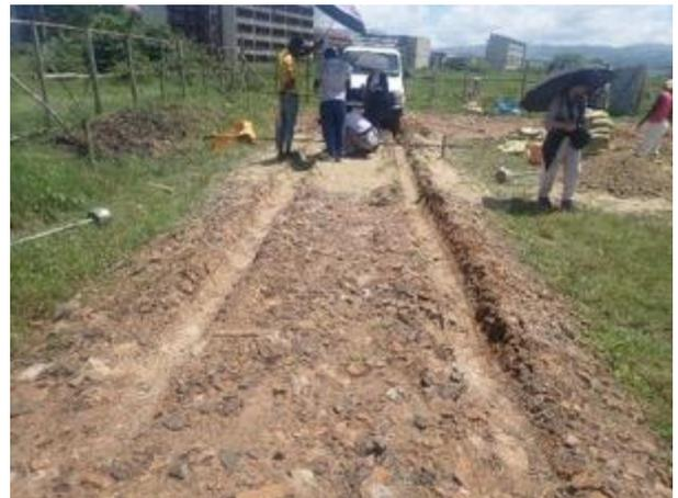
図 3-14 路面沈下量の計測
