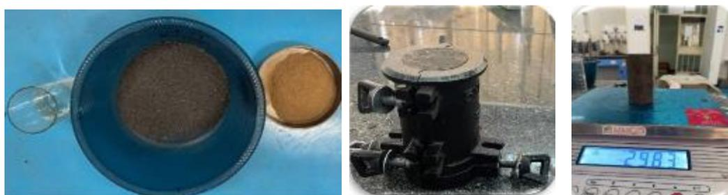
図 1-6 一軸圧縮試験用の試料準備
