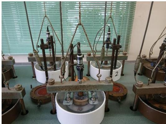
図 1-3 圧密試験用モールドを利用した膨潤試験
