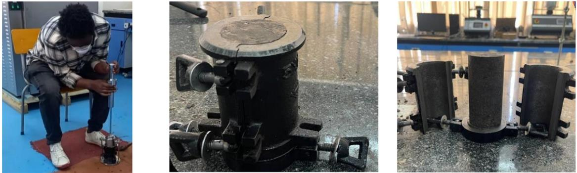
図 1-5 一軸圧縮試験用の試料作成状況
