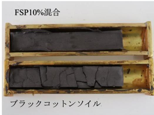
図 1-1 Linear shrinkage test
