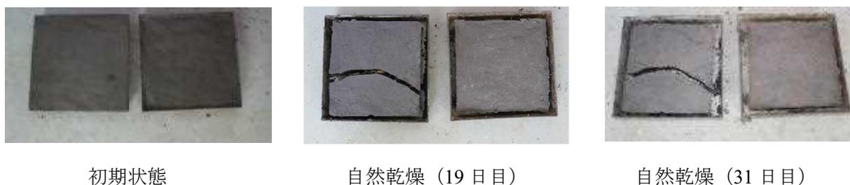
写真 1-2 セルドロン混合によるひび割れ発生抑制効果
