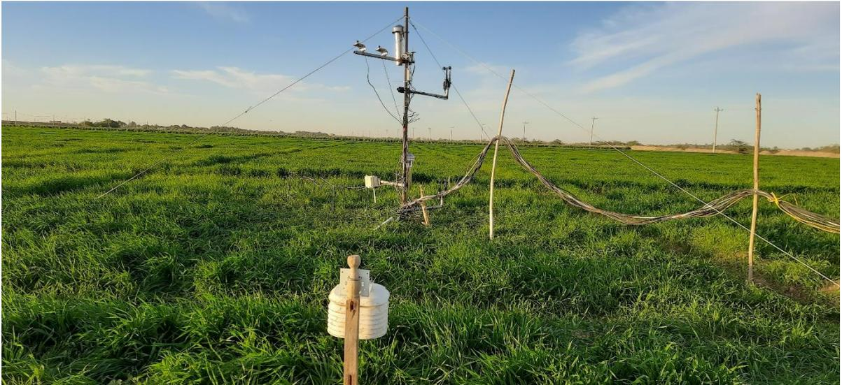
図8 ドンゴラの ARC 試験圃場に設置した微気象観測機器
