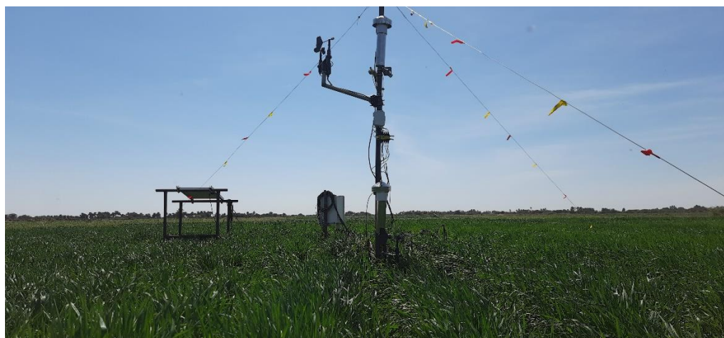
図 10 フダイバの ARC 試験圃場に設置した微気象観測機器（2023 年 1 月撮影）
