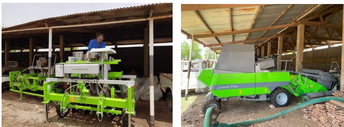
図 14 育種用機器。シードドリル（左）およびプロットハーベスター（右）
