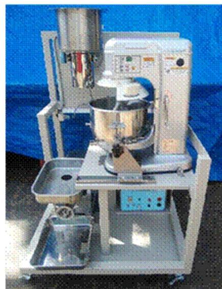
図5-2 飼料製造装置(プロトタイプ)
