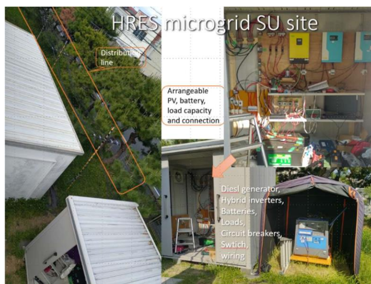
図 4-5 静岡大学における小規模マイクログリッド実験システム
