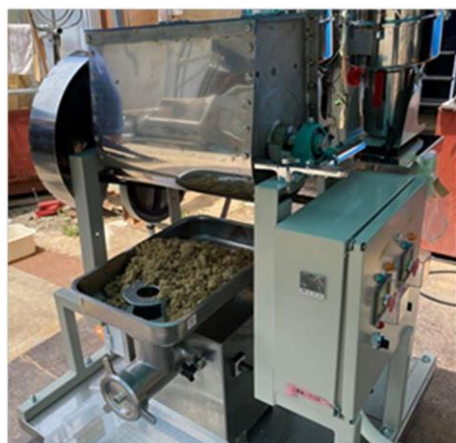
図 5-4 養魚用飼料製造装置(供与機)
