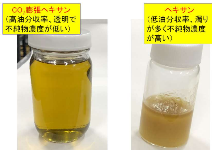
図3-6 CO 2 膨張ヘキサン抽出油とヘキサン抽出油の比較
