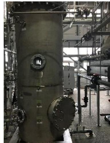
図 3 : Eva-Con 試験用小型 H-OTEC 試験装置
