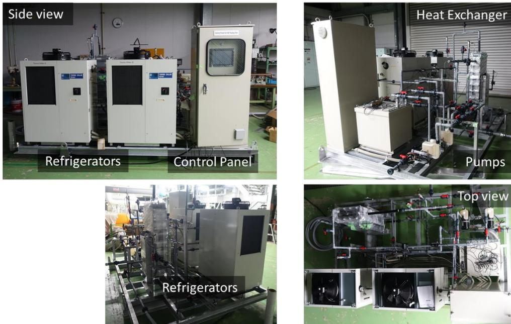
図 4：熱交換器汚れ試験装置
