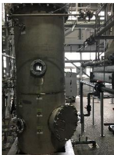
図 6 : Eva-Con 試験用小型 H-OTEC 試験装置
