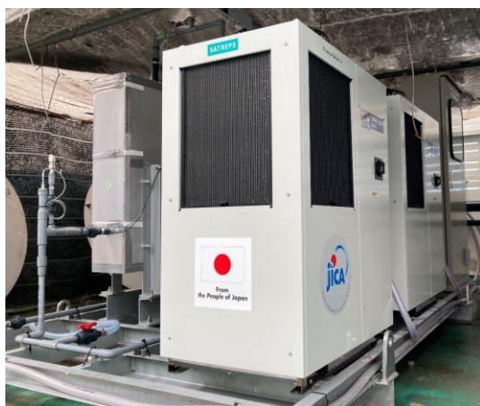
PJ3 : 熱交換器の汚れ試験装置
