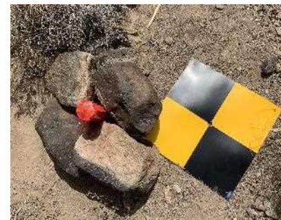
図 17 RTK 測量用ベンチマーク
