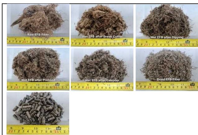
図 10. サラワク州 EFB ペレット製造への原料マルチ化プロセス爆砕機導入による EFB ファイバーの形状推移
