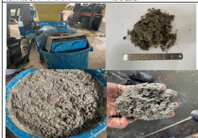
図 10. サラワク州 EFB ペレット製造への原料マルチ化プロセス爆砕機導入による EFB ファイバーの形状推移
