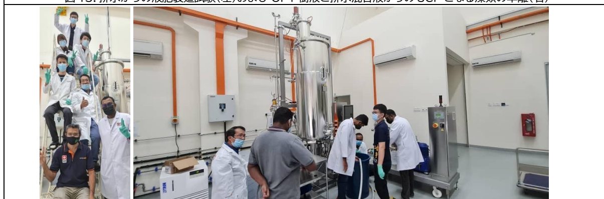
図 14. マレーシア理科大学 OPT-RL で行われている大型培養槽を用いた PHA 発酵試験
