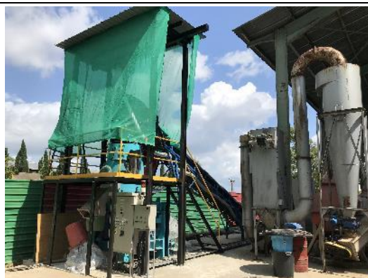
図 12. OPT 燃料ペレットのスケールアップ試験機
