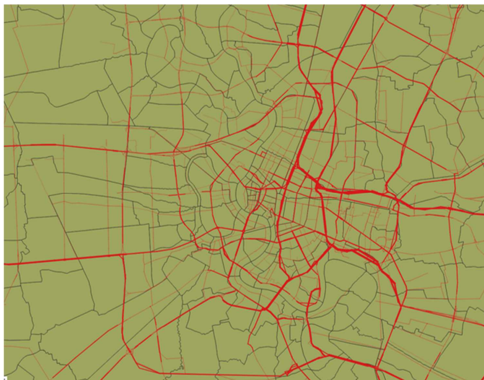
図3 MATSim による配分交通量の推計（試算）
