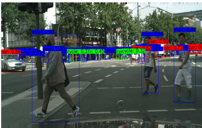
図 12 街中の画像の物体認識（左）・セマンティックセグメンテーション（右）の例
