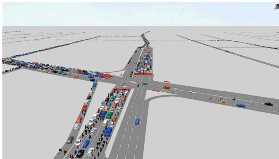
図 8 マイクロシミュレーションによる渋滞対策可視化システム
