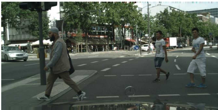
図 11 物体検出とセマンティックセグメンテーションを同時に行うディープラーニングモデル
