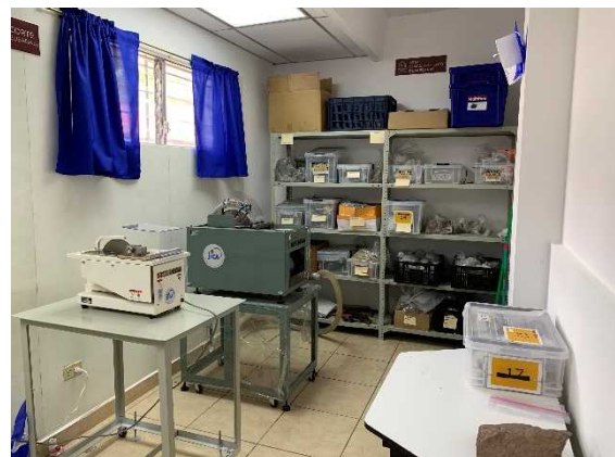
写真6 地質ラボ 岩石カッター・研磨機 (手前左・JICA 供与品)
