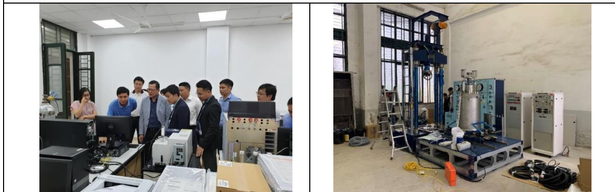
図5 ベトナム国立大学 SATREPS ラボ：左) 環境・材料実験室での予備トレーニングの様子、右) 路盤材の力学特性を評価するための大型三軸圧縮試験機
