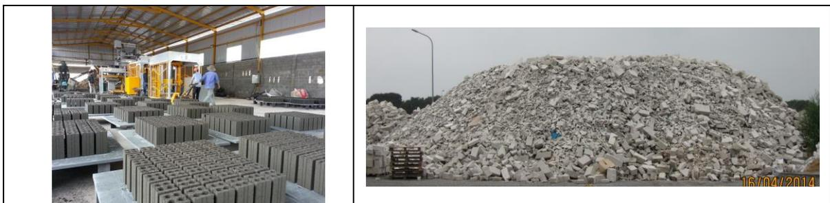
図 3 ハノイでの軽量気泡コンクリートブロックの製造（左）、山積みされた廃材（右）
