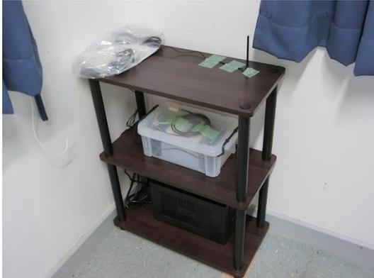
写真 13. アパリ気象台に設置した微気圧計
